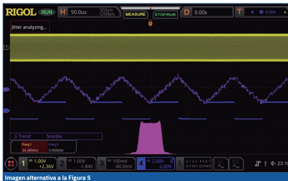
Figura 5: Resolución de problemas mediante análisis de jitter
