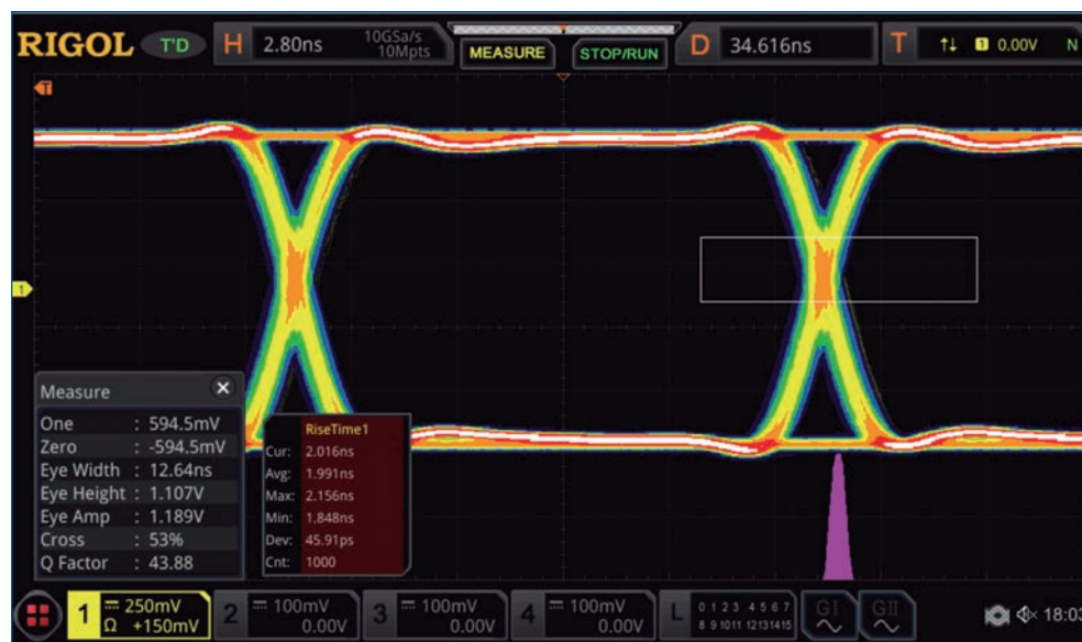
Figura 14: Diagrama de Ojo después de solucionar problemas y mejorar el diseño
